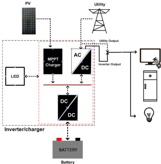
**Supported battery types:** AGM、GEL、FLD、LFP15/LFP16、LNCM14
