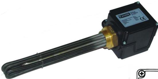
Eintauchheizkörper mit integrierter Isolierung zur direkten Wassererwärmung, besonders geeignet für emaillierte Behälter. Er besteht aus drei "U"-förmigen Rohrheizkörpern und einem Fühlerschutzrohr, das in einem Schraubenkopf G 1 1/2" montiert ist. Der Heizer ist mit einem Kunststoffgehäuse versehen, in dem sich ein Temperaturregler (30-75°) mit Begrenzer (98°C) und Kontrollleuchte befindet. Die isolierte Bauweise des Rohrheizkörpers schützt den emaillierten Tank vor Korrosion.
